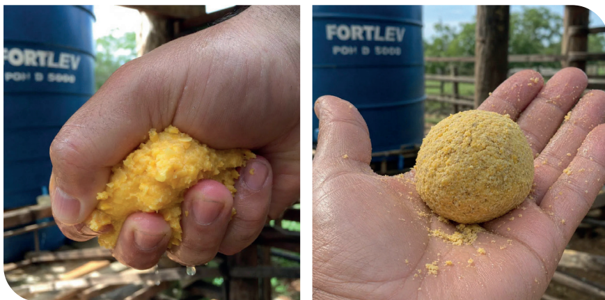
Figura 6: Teste do bolinho para verificar teor de umidade adequado na ensilagem de grãos úmidos
