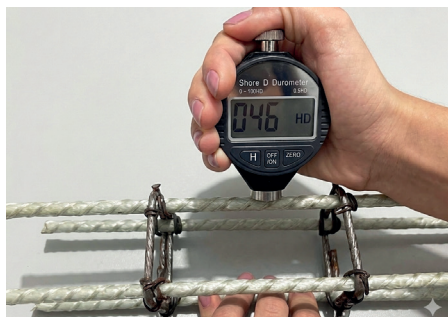
Figura 5: Procedimento para medidas de dureza Shore D
