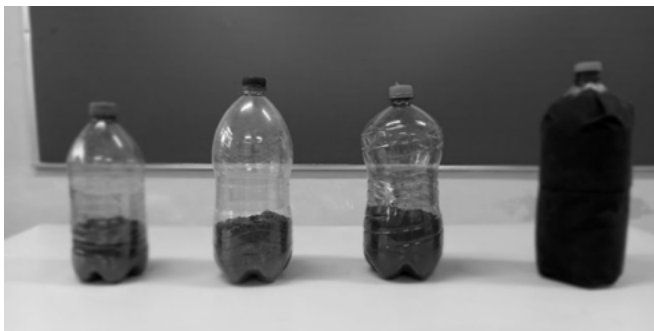
Figura 2: Miniestufas de garrafas PET em cores diferentes
