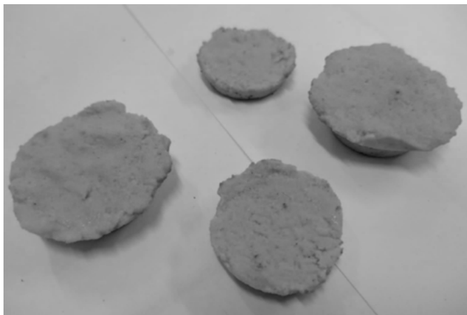
Figura 3: Bioplástico produzido a partir da proteína do leite
