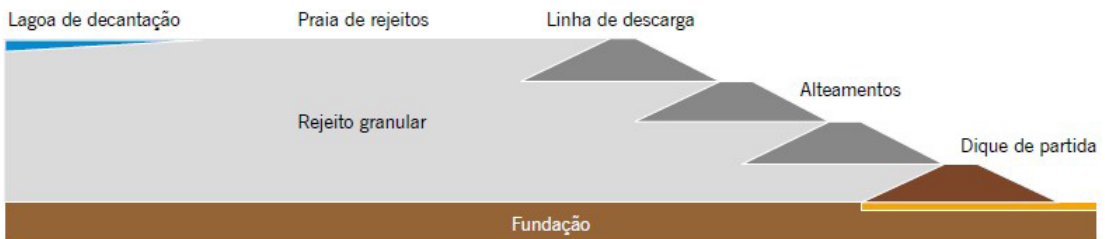
Figura 1: Alteamentos sucessivos: método da linha de montante
